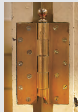
地下の鉄格子の蝶番。 爆風で吹き飛ばされた際に欠損
