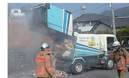
誤ったごみの出し方が原因で起きたごみ収集車の火災
