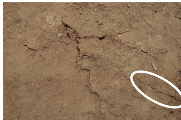
2024/1/18 亀裂 縦約 11.2cm 横約 17.7cm 白丸部分に新たな亀裂を確認した。
