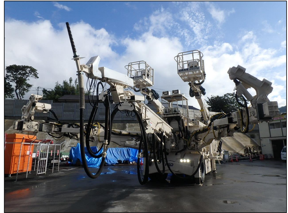
吹付ロボット
