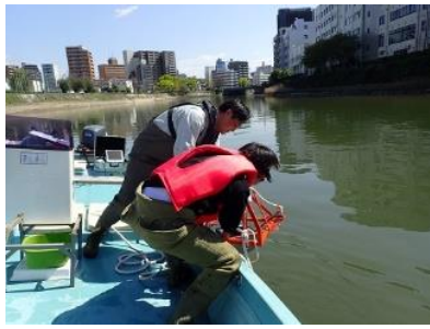
スミス・マッキングタイヤ採泥器でサンプリング
