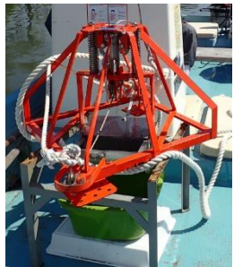
スミス・マッキングタイヤ採泥器でサンプリング
