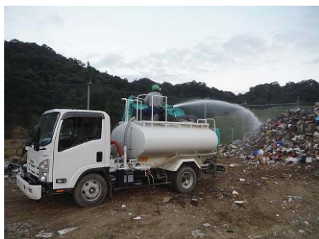
写真 1-2-4 散水車両を活用し洗浄
