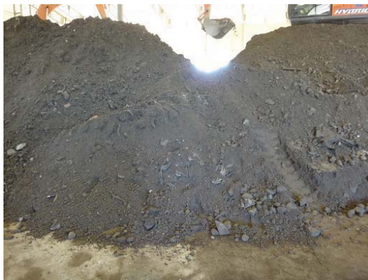
写真 5-2-1 土砂内に紛れ込む劣化した「土のう袋」の切れ端
