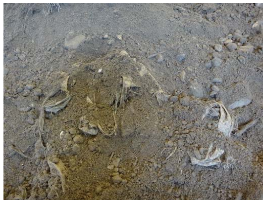
写真 5-2-1 土砂内に紛れ込む劣化した「土のう袋」の切れ端
