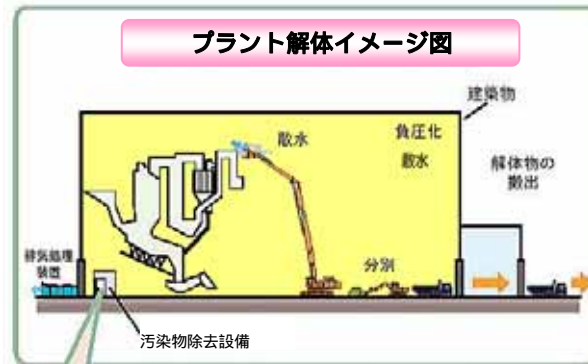
工程図 プラント解体作業の例です。
