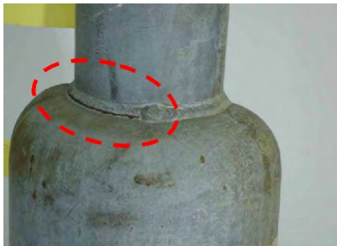
照明柱断面変化部の溶接に確認されたき裂 （歩道橋、15年経過）
