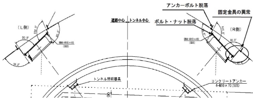
図-4.15 附属物の異常発生箇所の例
