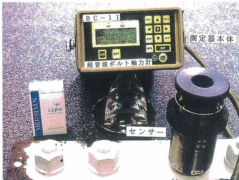
参考写真 5-1 超音波ボルト軸力計の構成
