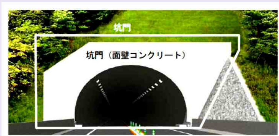
図-4.2 点検対象箇所（トンネル坑口部）
