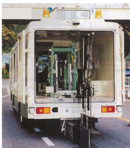
<写真 4.1-1>車載型 FWD の外観例
