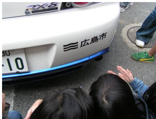
排気口から水が出た!
