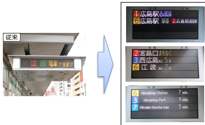
図-62 高度化された電車ロケーション表示器
