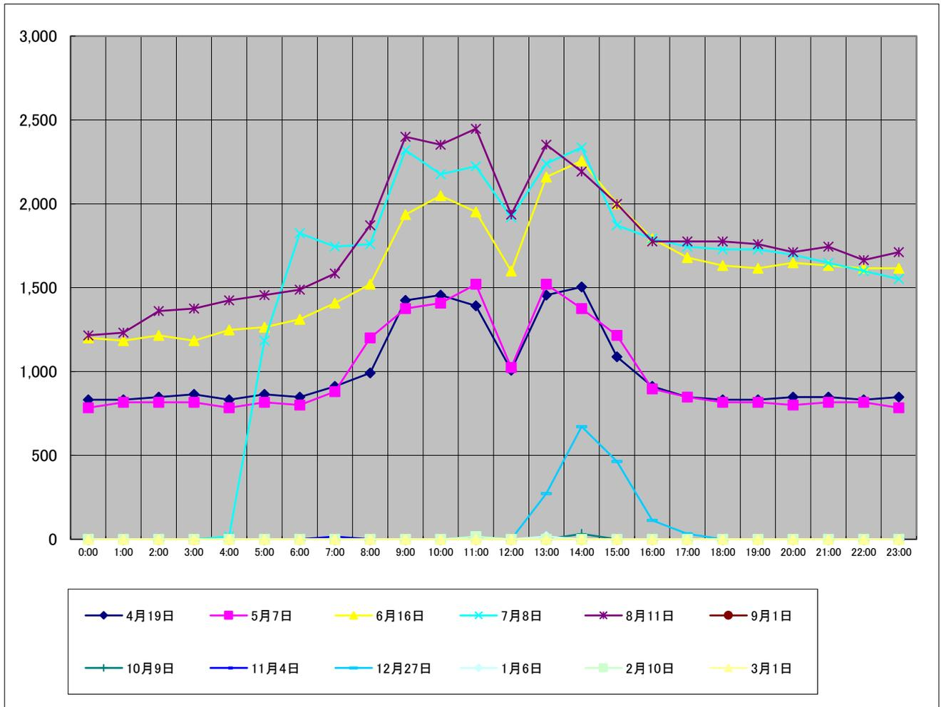
安佐北工場 令和3年度最大使用電力日における負荷曲線(単位:kWh)
