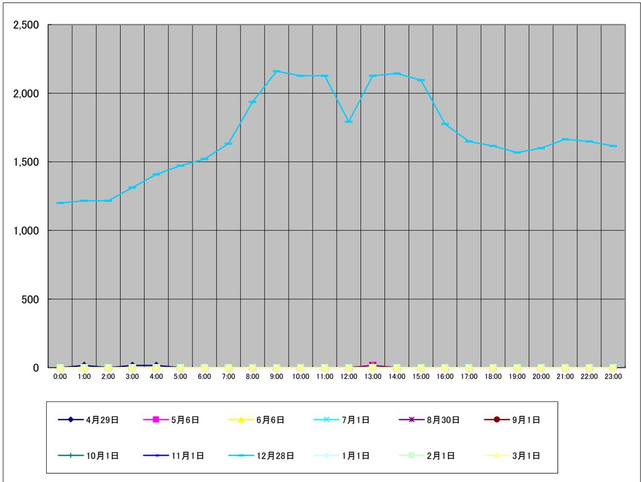
安佐北工場 令和4年度最大使用電力日における負荷曲線(単位:kWh)
