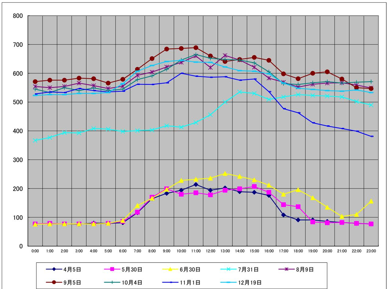
中工場 令和5年度最大使用電力日における負荷曲線（単位：kWh）
