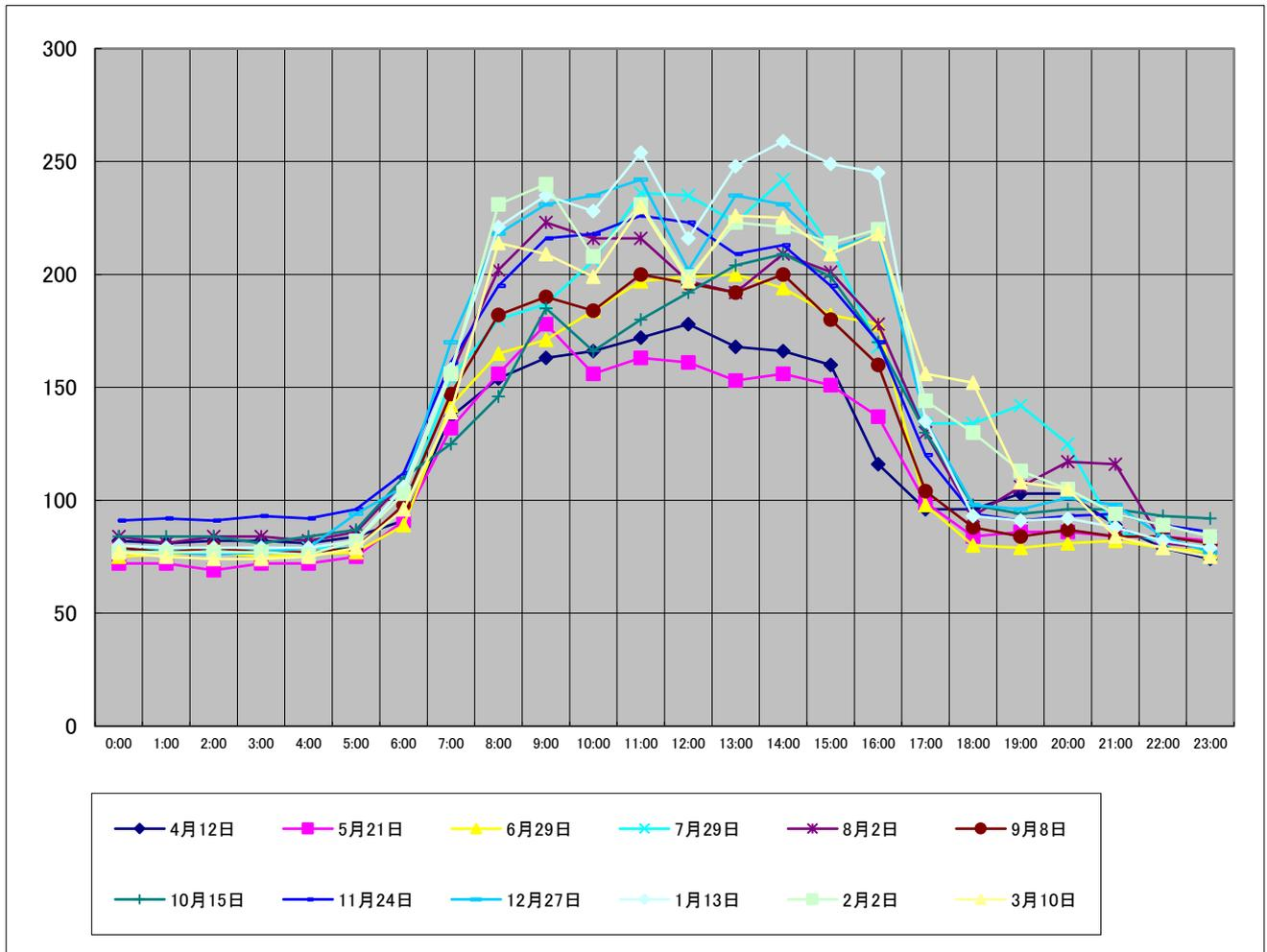
中工場 令和4年度最大使用電力日における負荷曲線（単位：kWh）
