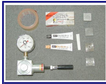
測定機器 建研式引っ張り試験機 アタッチメント（4×4 cm 2 ・スチール製） 2液型速乾性エポキシ樹脂接着剤
