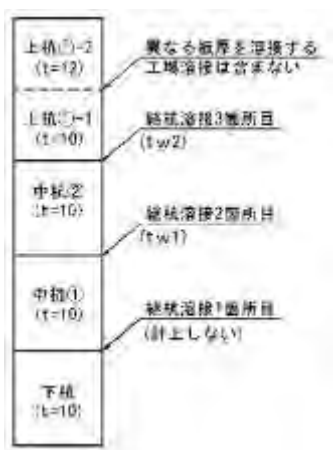
図 5-1 継杭溶接箇所 (参考図)
