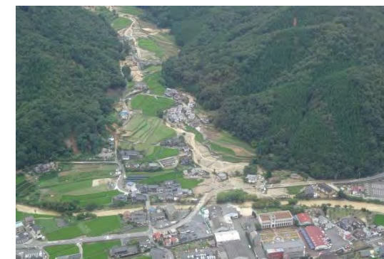
写真 5-16 大林町高谷川周辺 高谷川の最下流部では土砂流出により付近の宅地や農地に被害が発生しました。
