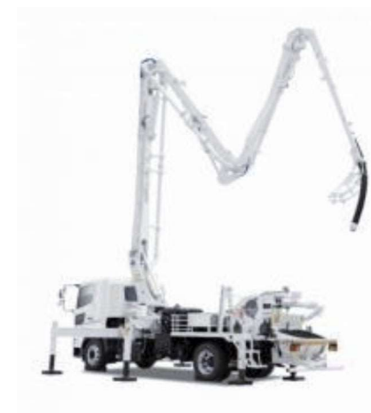
コンクリート ポンプ車
