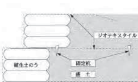
図B 巻き込み工法(植生土のう)参考図
