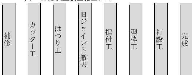
図-1 伸縮装置設置施工フロー
