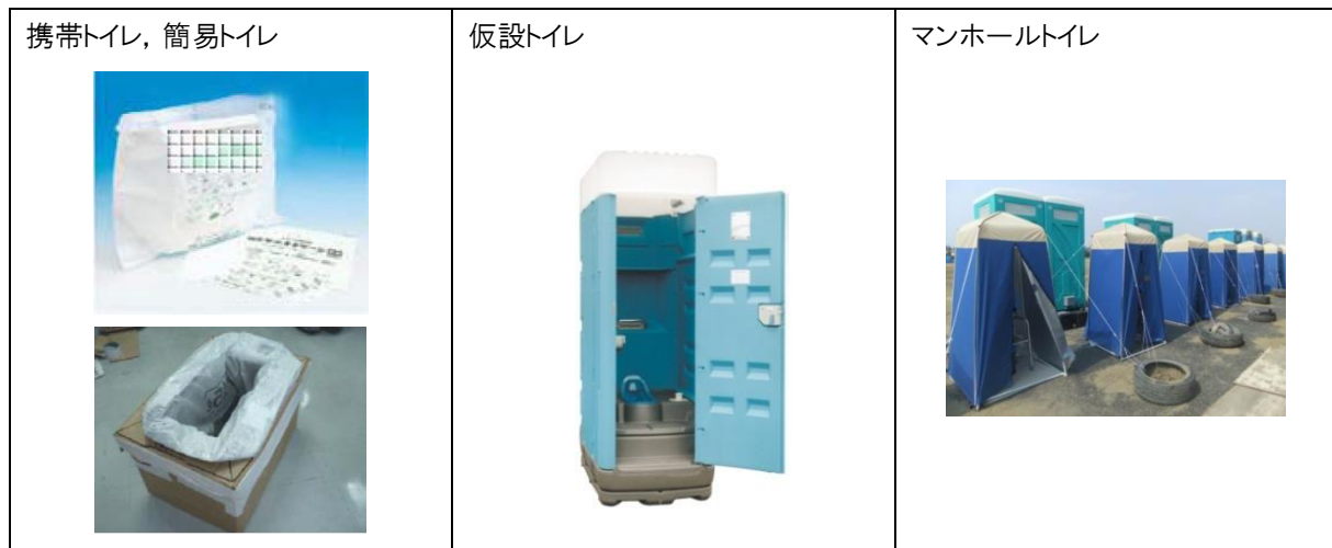
図 2-30 仮設トイレ等の例
