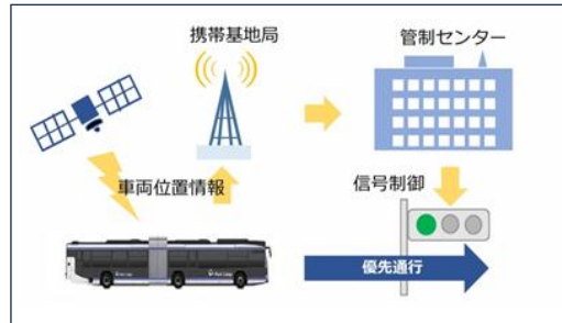
人工衛星によりバスの位置情報を把握し、交差点に近づいたことを認識すると青信号が最大10秒延長する「バス優先信号システム」（神戸市が令和6、7年度に実証実験を実施）
