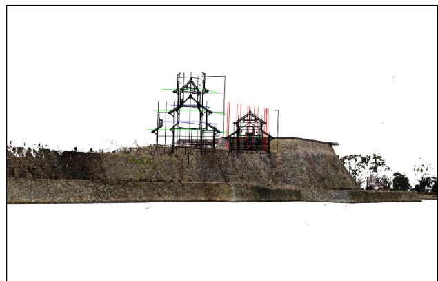
④ 古写真の撮影位置から見た3次元データ： 図化したラインも含めて古写真撮影位置から 3次元データを見る
