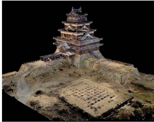
東・南小天守台を対象として計測された点群データ (広島城小天守台等石垣現況調査業務 R5.3)
