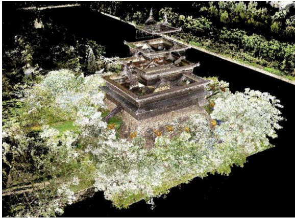
大天守台を対象として計測された点群データ (広島城天守台石垣現況調査業務 R4.3)
