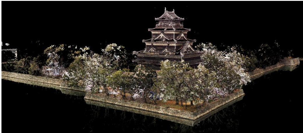
内堀石垣を対象として計測された点群データ (令和5年度現地予備調査)
