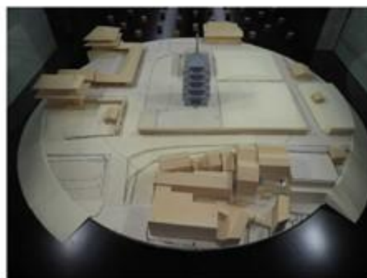
図 82 風洞試験模型の事例 文化財建造物構造実験データ集 2502 興福寺五重塔の風洞実験（清水建設）より
