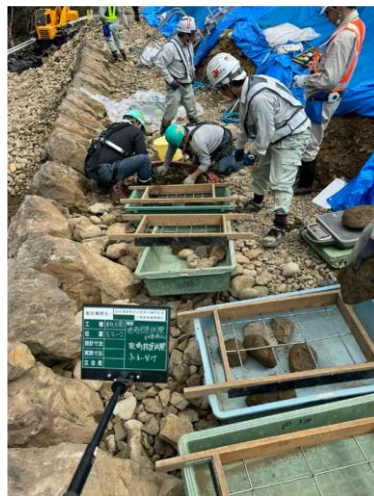
粒度試験(現地作業)
