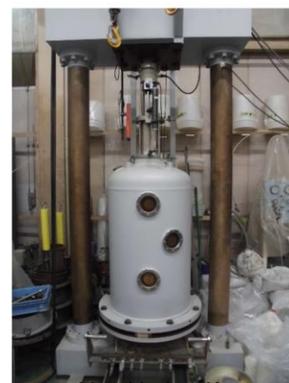
三軸圧縮試験装置
