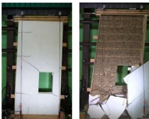
図 81 土壁試験体の静的加力試験の事例 日本建築学会大会学術講演梗概集（関東）2020年9月 大規模伝統木造建築における構造要素の性能評価に関する研究その5 土壁試験体の施工および実験結果（竹中工務店）より
