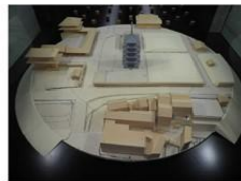
写真 3-3 風洞試験模型の事例
