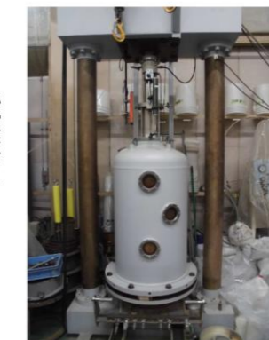
三軸圧縮試験装置
