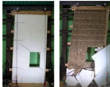
写真 3-2 土壁試験体の静的加力試験の事例
