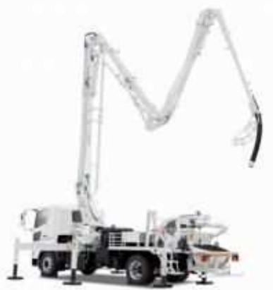
コンクリート ポンプ車
