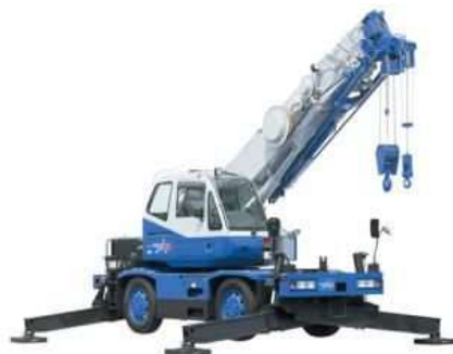
ラフタークレーン
