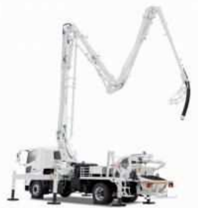
コンクリート ポンプ車
