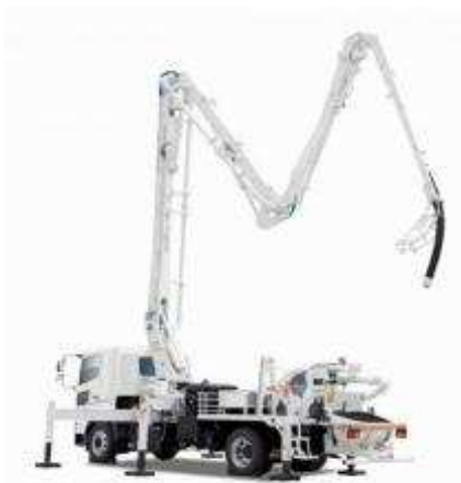
コンクリート ポンプ車
