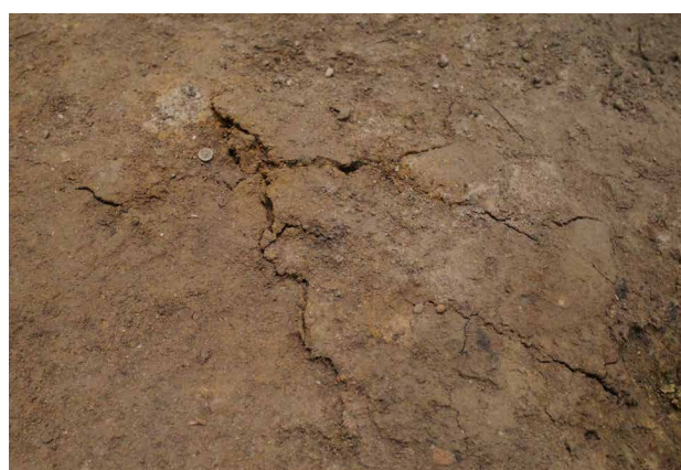
2024/2/15 亀裂 縦約 11.4cm 横約 19.6cm 亀裂が硫酸塩が析出した場所まで広がっている。
