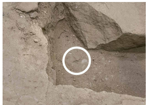
2022/8/24 拡大写真 亀裂がはじめて確認された
