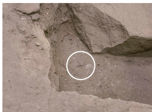
2022/8/24 拡大写真 亀裂が初めて確認された。
