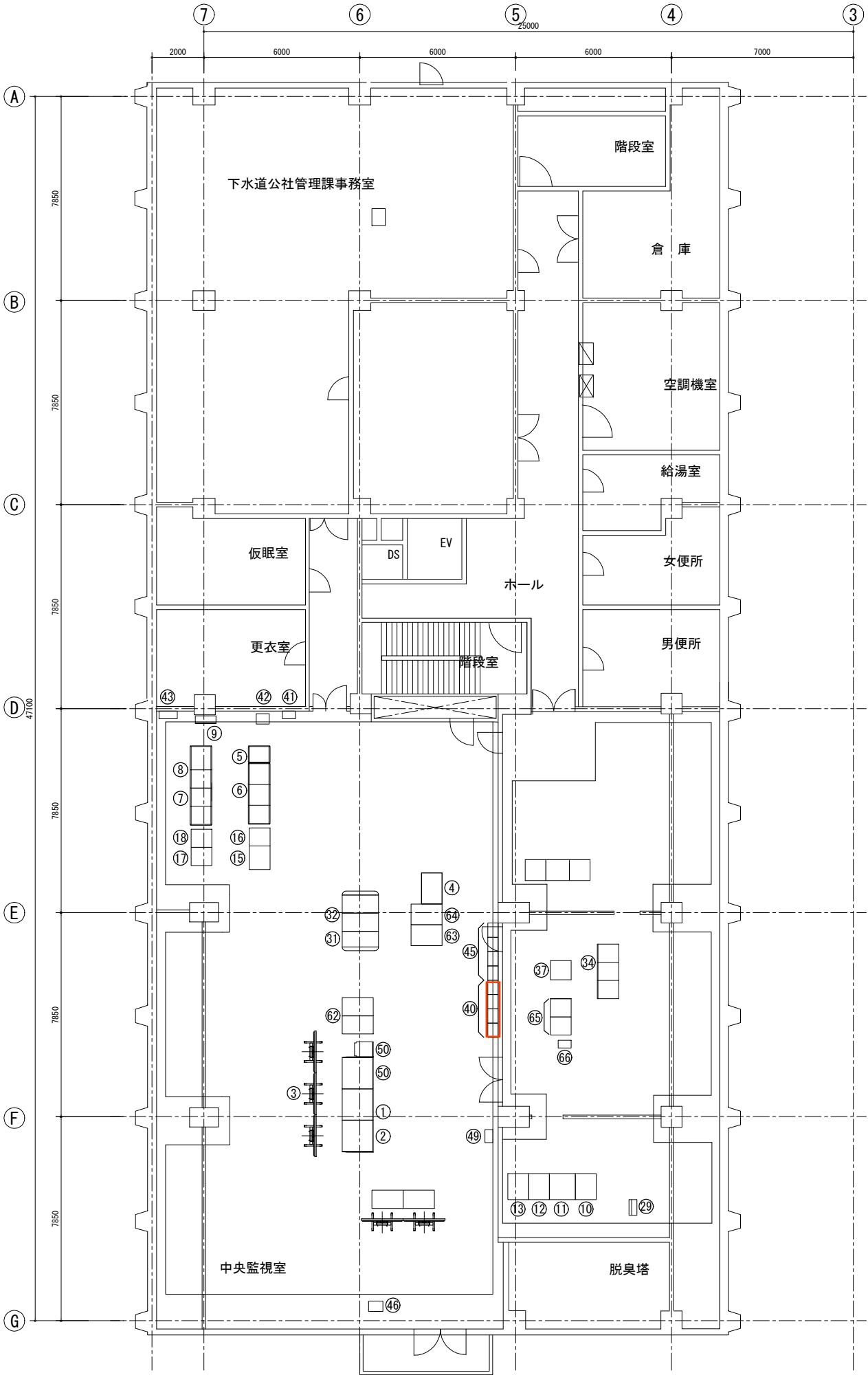
管理棟3階中央監視室平面図 S=1/100
