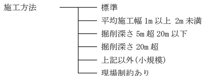
注) 1. 施工方法「上記以外(小規模)」とは、1箇所当りの施工土量が 100m<sup>3</sup> 程度まで、又は平均施工幅 1m 未満の床掘りで、「1箇所当り」とは、目的物 1箇所当りであり、目的物が連続している場合は、連続している区間を 1箇所とする。
