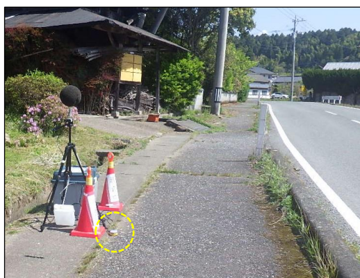
【振動レベル（振動レベル計）】
