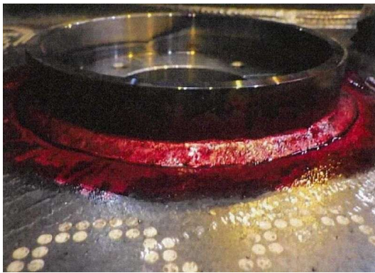
図 4.30 浸透探傷検査状況
