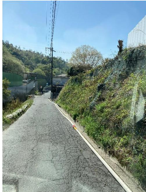
送水時、水の流動に障害となるのが、勾配の背圧、ホースの長さによる摩擦損失です。
