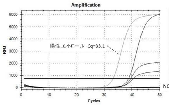
図1 微量 Ks 遺伝子の検出結果(1回目, 6 ウェルで測定)
