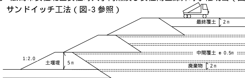
図-3 埋立方法 (サンドイッチ工法)
