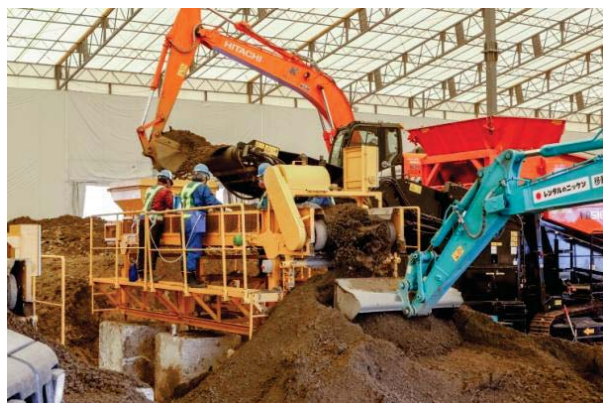
写真 3-5-10 手選別用ベルトコンベア
