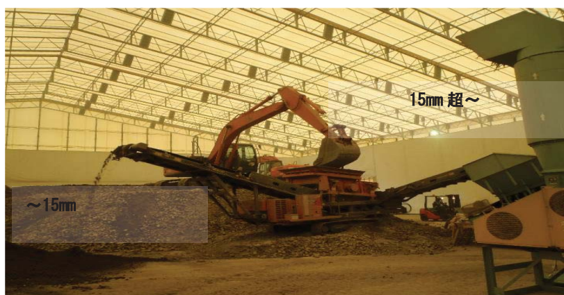
写真 3-5-12 振動スクリーンによる分別
