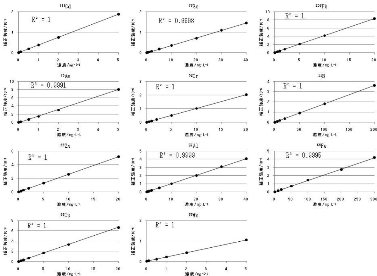
図 1 各測定元素の検量線
