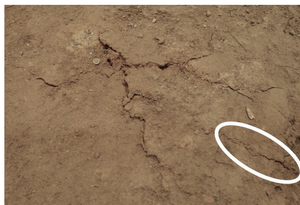
2024/1/18 亀裂 縦約 11.2cm 横約 17.7cm 白丸部分に新たな亀裂を確認した。
