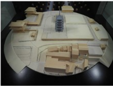
写真 3-3 風洞試験模型の事例
