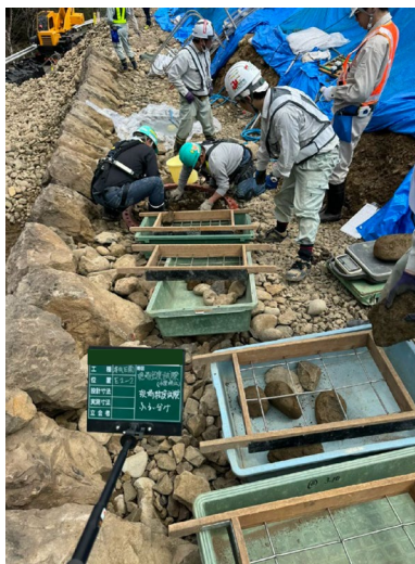
粒度試験 (現地作業)
