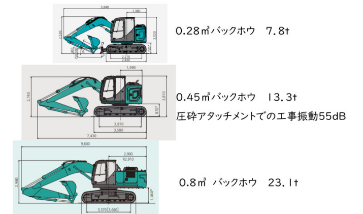
図 18 重機本体の大きさと重量比較
