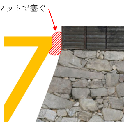
図 31 防護マットで隙間を塞ぐイメージ図
