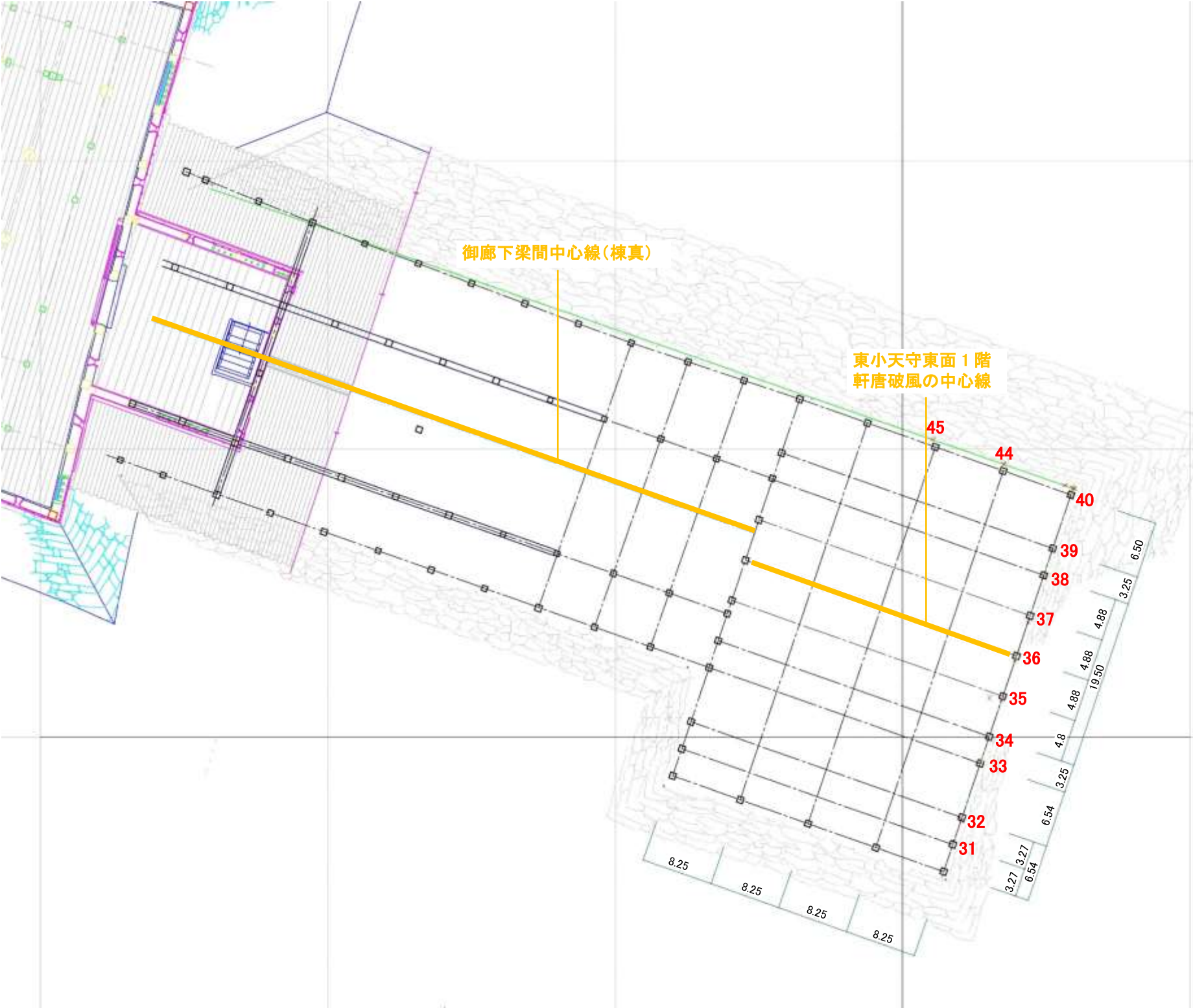
広島城東小天守 1階柱間寸法推定図 (単位:尺)
