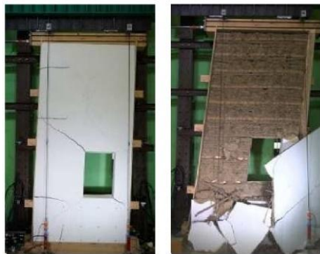
写真 3-2 土壁試験体の静的加力試験の事例
