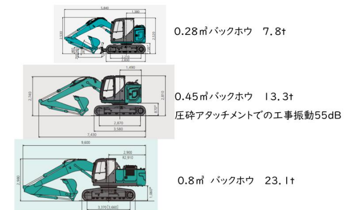
図 18 重機本体の大きさと重量比較
