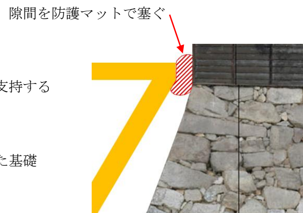
図 31 防護マットで隙間を塞ぐイメージ図
