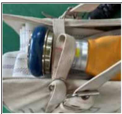
⑧メス金具がホースバッグから落下しないようにバンドできつく締め付けて固定する。
