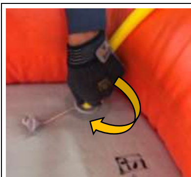
⑧エアバルブのキャップを軽く押し込みながらカチッと止まるまで右に回す。
