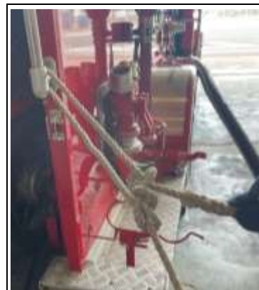
⑥吸管控え網を車両やフェンスなどの強固なものに結索する。
