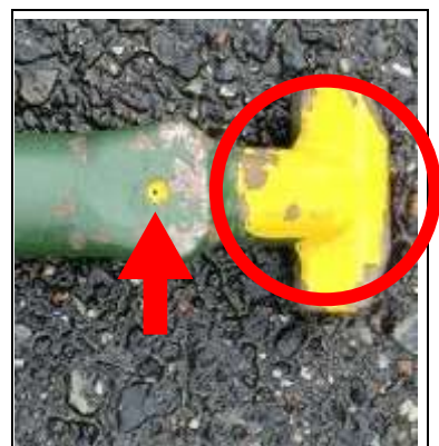
③差し込む場合、黄色の○印及び黄色の先端がどちら側に来てるのかを確認する。
