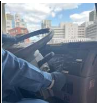
①車両のＰＴＯスイッチを押す。
