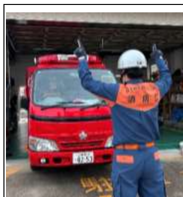
⑥赤色灯 「赤色灯よし！」 ※車両後ろ側の団員は、車両 後方の赤色灯が点灯した場合 警笛を吹く。
