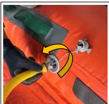
⑦アダプターを反時計回りに回しホースを取り外す。
