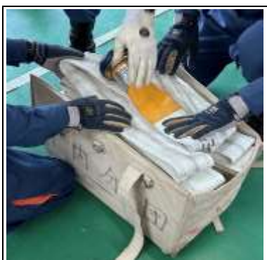
⑦メス金具まで収納したら、バッグの一番手前にメス金具を位置にする。
