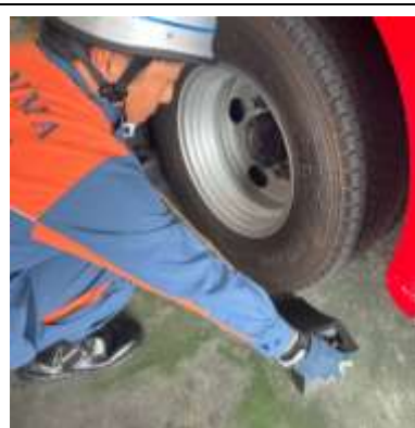
②ポンプ車に車輪止めを設定す。
