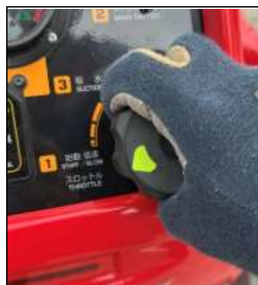
⑨スロットルダイヤルを「始動/低速」にする。
