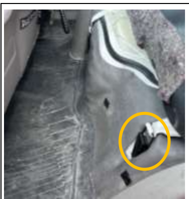
①助手席のシートを上げるた め、ロックを解除する。
