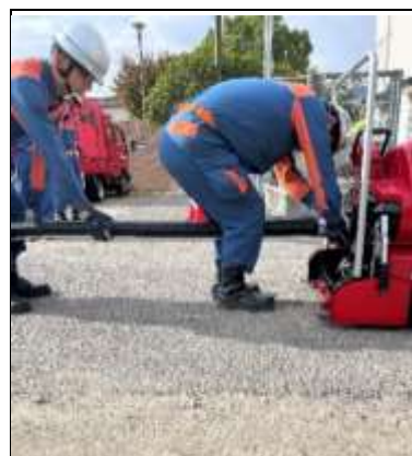
③吸管と可搬ポンプを接続する。
