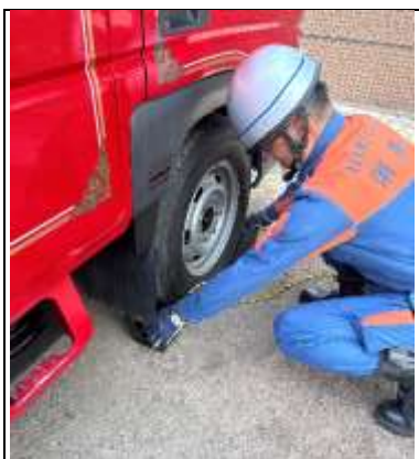
①積載車に車輪止めを設定する。
