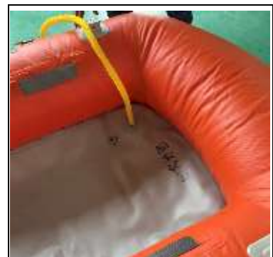
⑨エアフロアをボート本体の中に入れ込み、フットポンプでエアを注入する。
