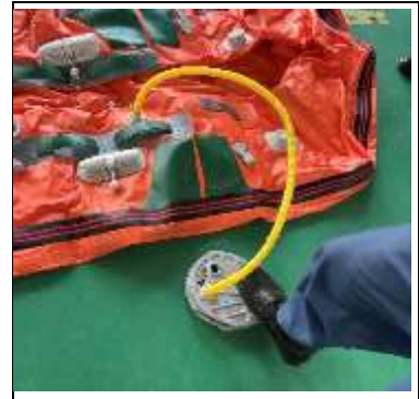
③フットポンプでボート本体に空気を入れる。
