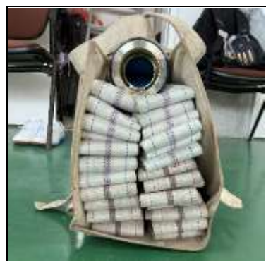
⑨ホースは、2列に収納し、メス金具が一番上にくるようにして、収納完了。
