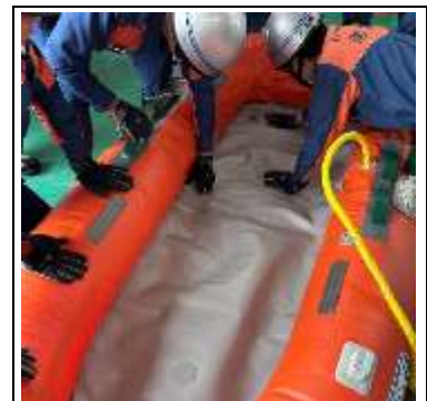
⑥ボートの底に隙間なくエアフロアをセットする。
