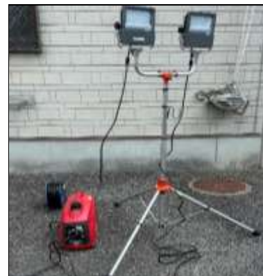
③発電機にプラグを差し込み完成。
