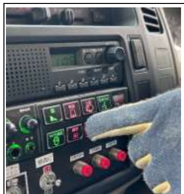
⑨運転手は、「弱」「減音」の ボタンを押下し、サイレン、 警鐘、モーターサイレン、マ イクを順番に確認。
