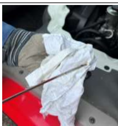
⑤オイルレベルゲージを引き抜いたら、一度拭き取る。
