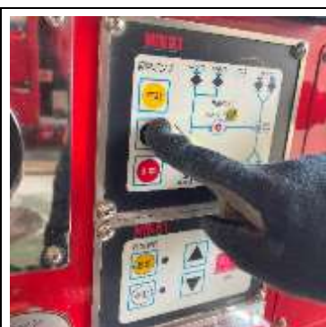
④連成計の針が、-0.1近い表示になったら停止ボタンを押す。 (真空ポンプの作動が自動で止まる車両もある。)
