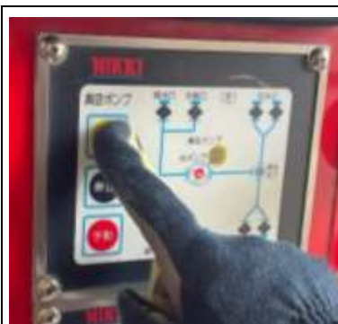
②下車し、真空ポンプボタンを押下する。
