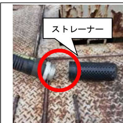
①吸管のストレーナーを取り外す。
