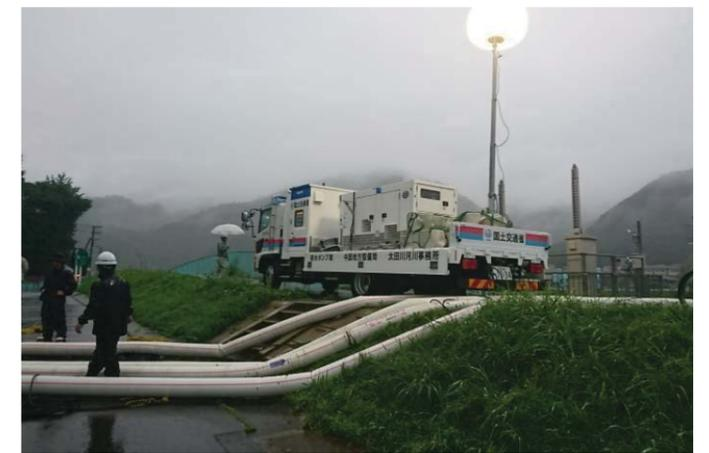
図9-1 排水ポンプ車出動状況のイメージ図
