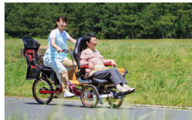
<介護用から宅配用まで幅広い使い方ができる前2輪電動アシスト自転車を開発(TRIKE CARRY前輪2輪電動アシスト自転車)>
